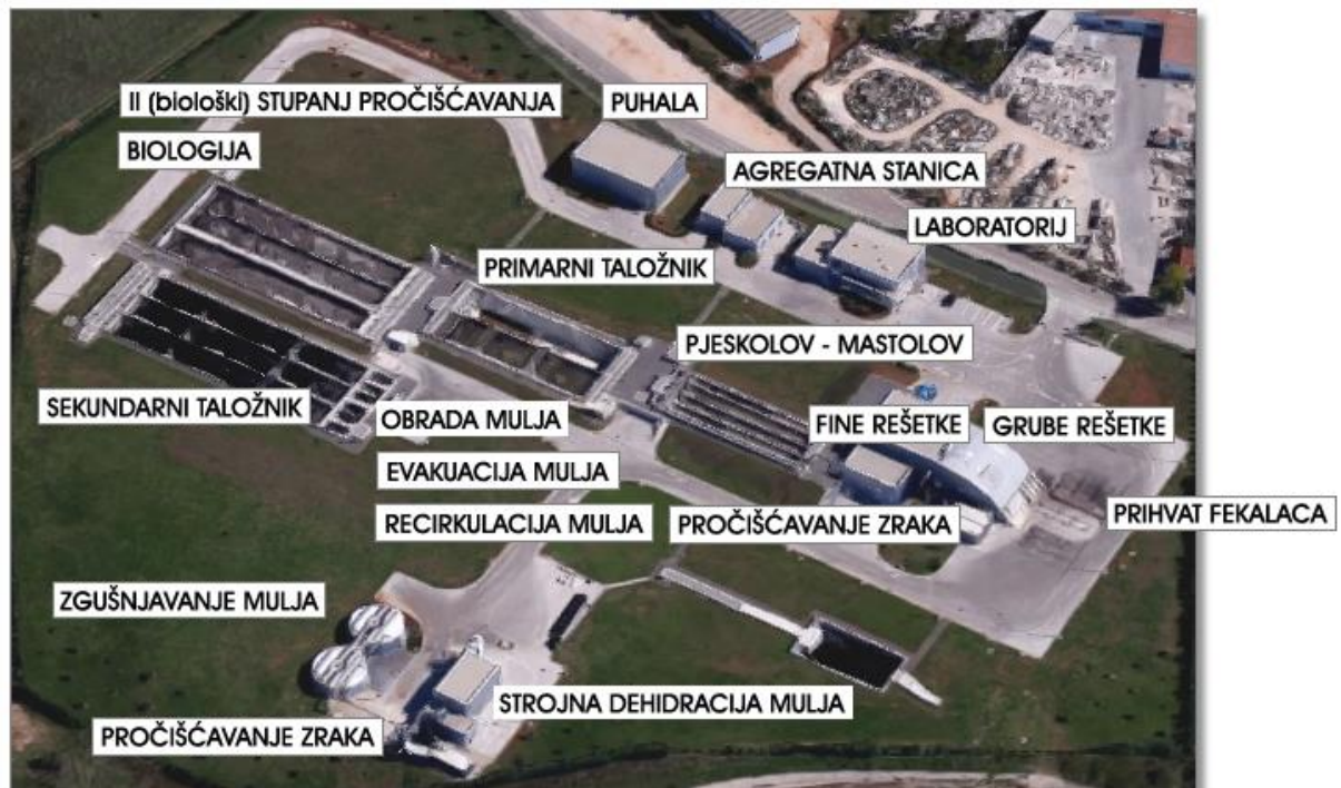
Slika 2-3 Postojeći UPOV Zadar Centar s naznačenim elementima (izvor: www.odvodnja.hr )
